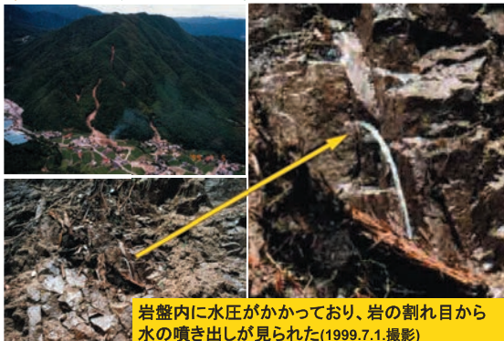
立木が多方向に傾いているのは地盤が流動化に近い状態になった証拠。溪床にはいくつかの穴と、その中に水流も認められた。
