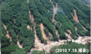
源頭部崩壊箇所からの水の湧き出しや流下しているのが見える
